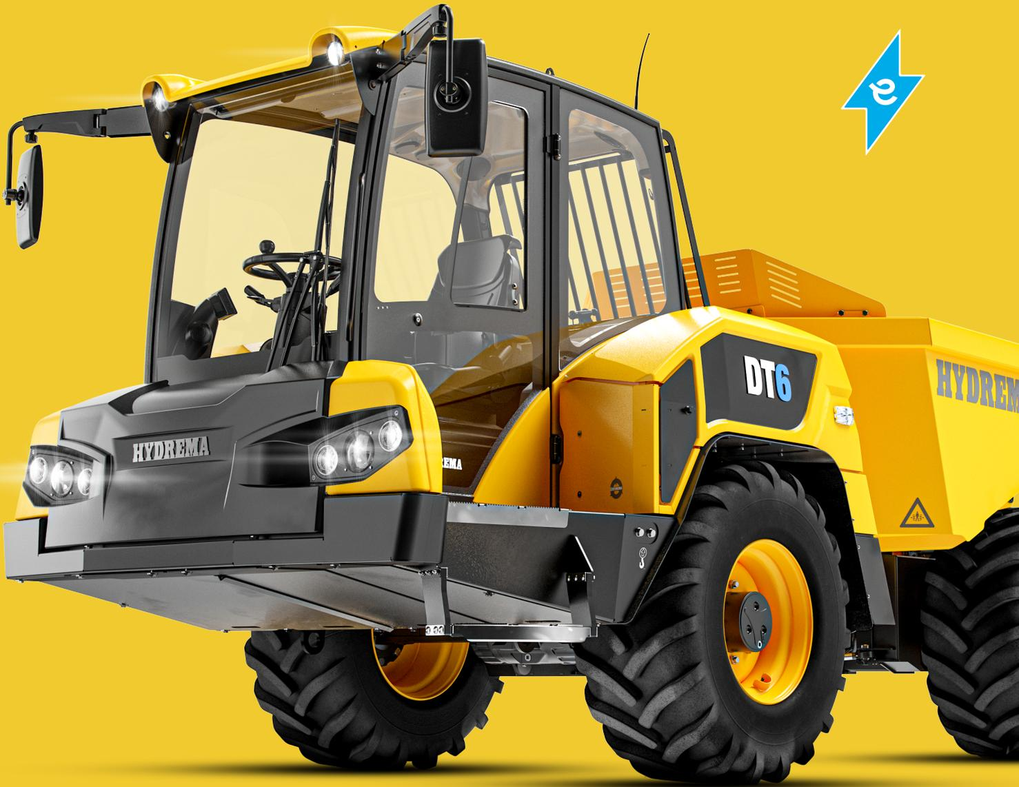
**THE FUTURE OF ZERO-EMISSION EARTHMOVING! THE DT6 COMBINES ELECTRIC DIRECT DRIVE AND ON DEMAND HYDRAULICS.**
